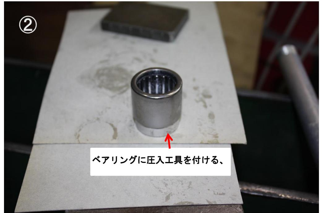
GPZ900R ピボットベアリング圧入・抜き方作業参考下さい
